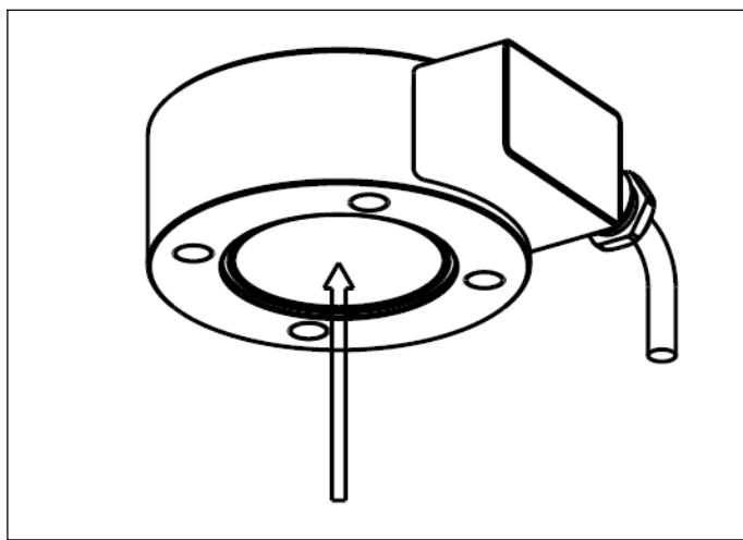
Abb. 17.1 Das Blech am Boden des Sensors darf nicht beschädigt werden, da sonst keine hermetische Kapselung gegeben ist
