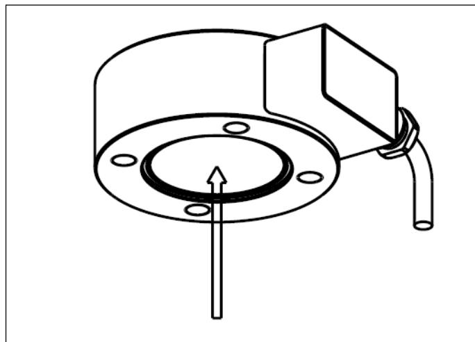
Fig. 41.1 La lamina di protezione sul fondello del sensore non deve essere danneggiata, altrimenti si perde l'effetto dell'incapsulamento ermetico.
