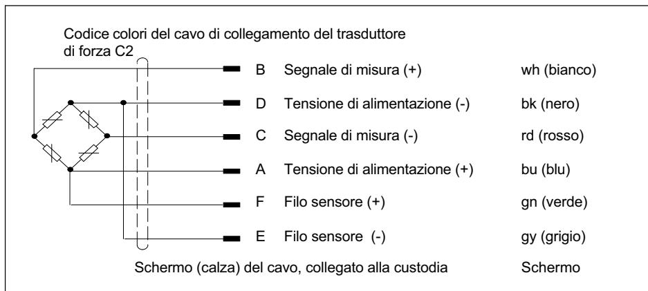
Fig. 44.1 Cablaggio del circuito a 6 fili
