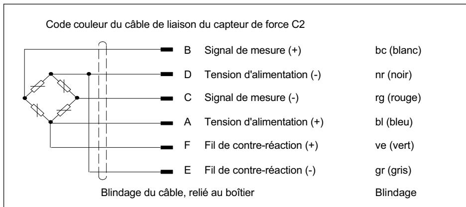
Fig. 32.1 Code de raccordement en câblage six fils
