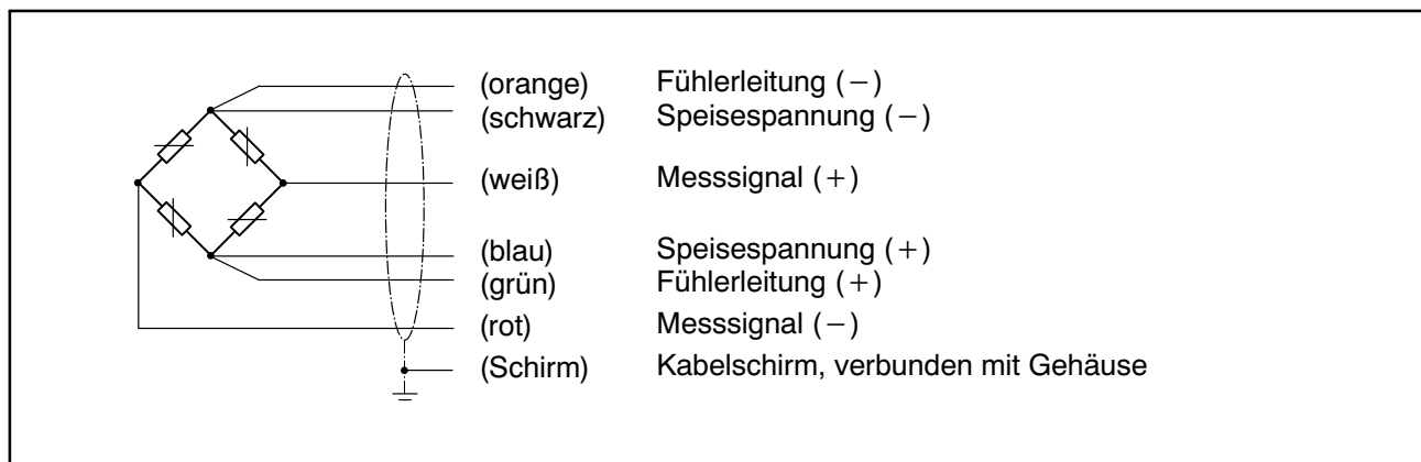
Abb. 6.1: Anschlussbelegung in Sechseiter-Schaltung
