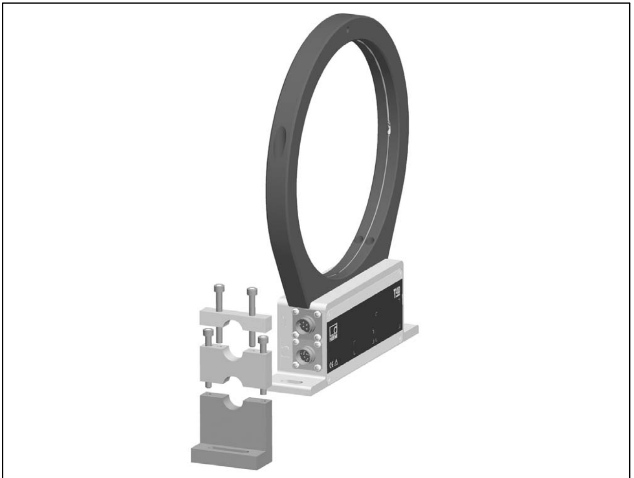
Abb.3.5: Konstruktionsbeispiel für eine Steckerklemme (für zwei Stecker)
