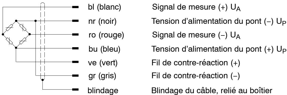
Fig. 6.3: Code de raccordement de Z4A
