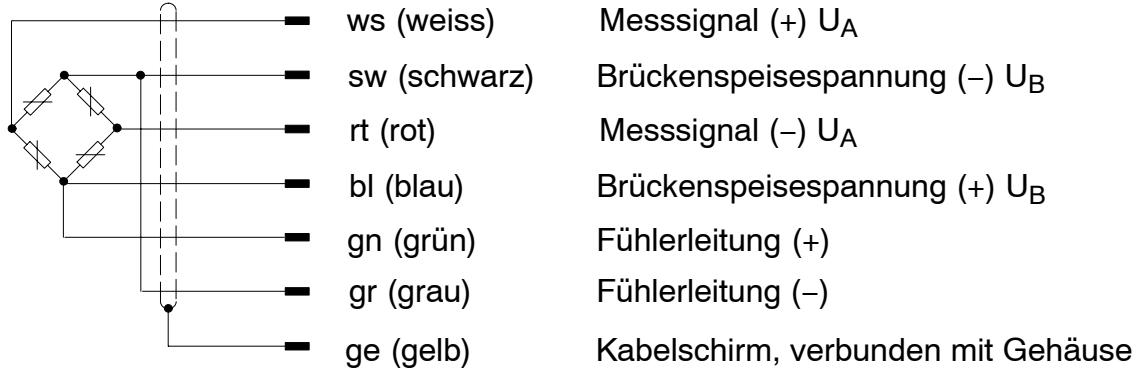
**Abb. 6.1:** Anschlussbelegung des Z4A
