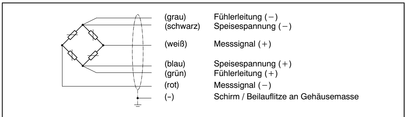
Abb. 6.1: Anschlussbelegung der RSCC in Sechsheiter-Schaltung
