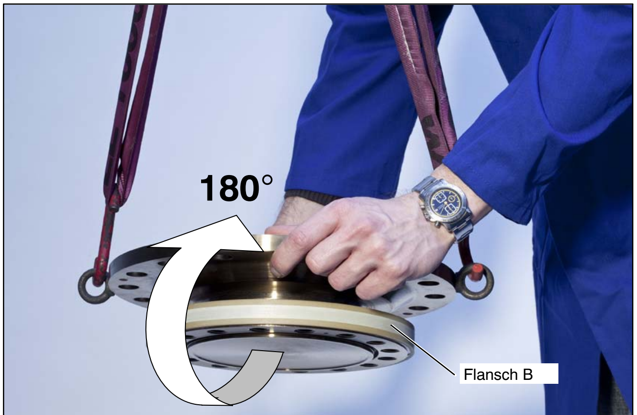
Abb. 4.2: Drehen des Rotors
