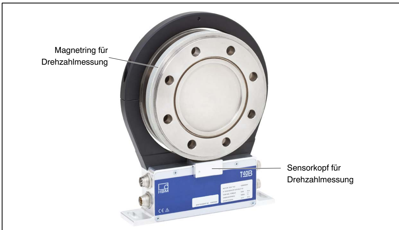
Abb. 4.15: Drehmomentaufnehmer mit Drehzahlmessung
